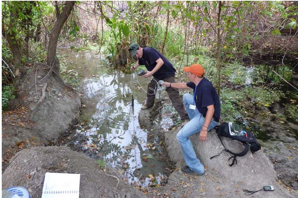
Figura 81.- Midiendo mediante sonda multiparamétrica en un arroyo cercano al pozo.
