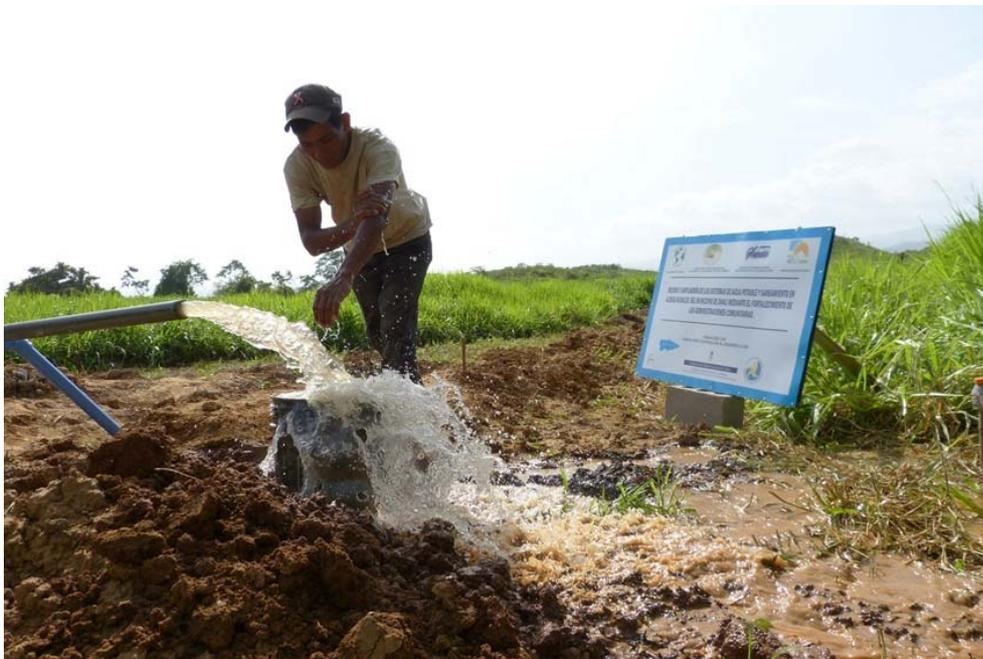
**Figura 117.- Probando y cubicando mediante método volumétrico en la boca del pozo.**
