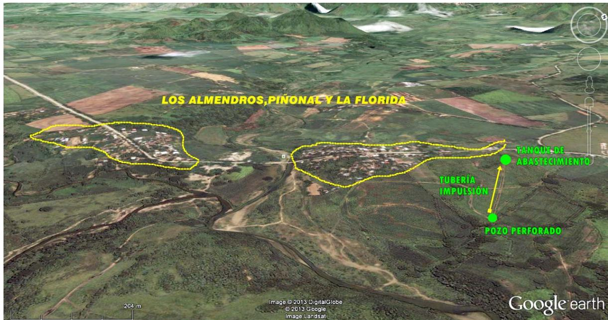
*Figura 16.- Vista con las principales actuaciones planteadas en Los Almendros. El tanque de almacenamiento no estaba inicialmente contemplado, aunque se ejecutó.*
