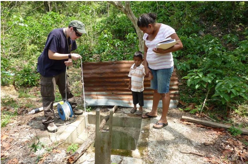
*Figura 21.- Midiendo niveles y parámetros de agua en pozos existentes.*
