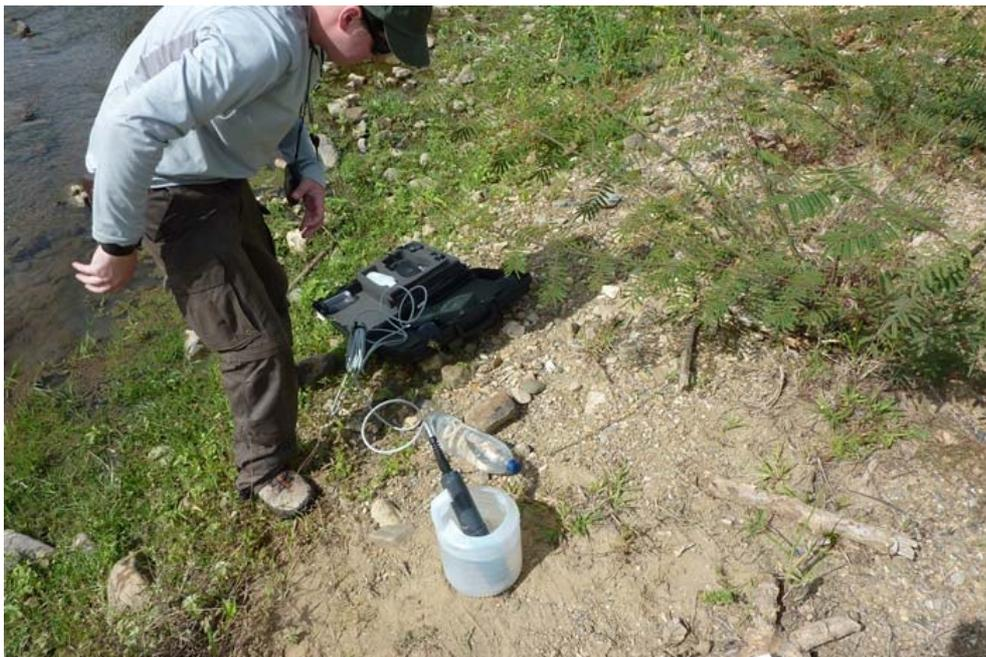
**Figura 152.- Midiendo mediante sonda multiparamétrica en un arroyo cercano al pozo.**
