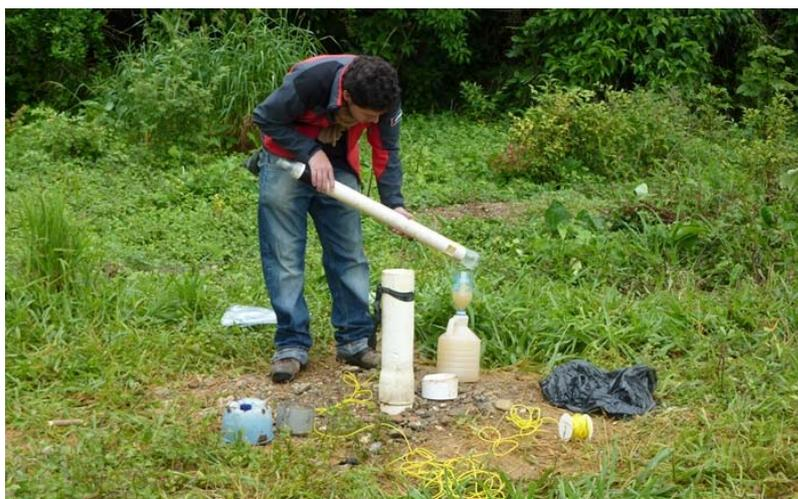
*Figura 169.- Tomando muestra mediante un tomamuestras "casero" para pozos.*
