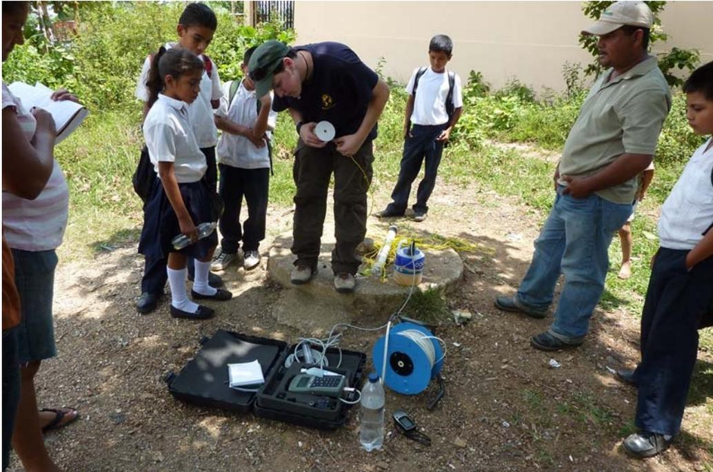
**Figura 23.-** Parámetros de agua y niveles en pozo perforado.
