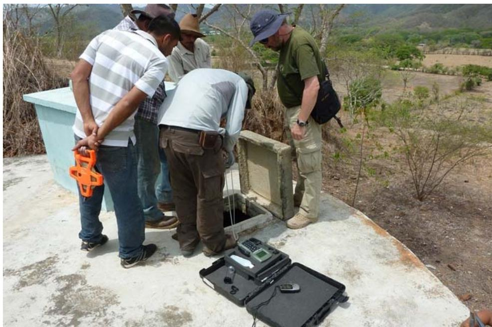
**Figura 154.- Medida de parámetros del agua del tanque mediante sonda multiparamétrica**
