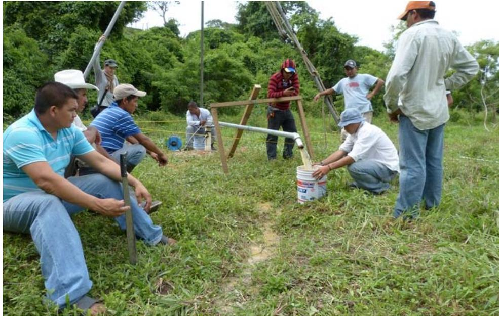
*Figura 166.-Realizando el aforo volumétrico para regular el caudal de bombeo.*
