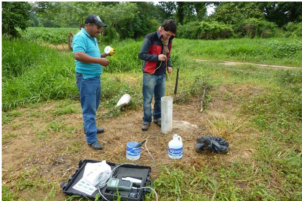
**Figura 98.- Toma de muestras, con medición de parámetros físicos con la sonda multiparamétrica.**
