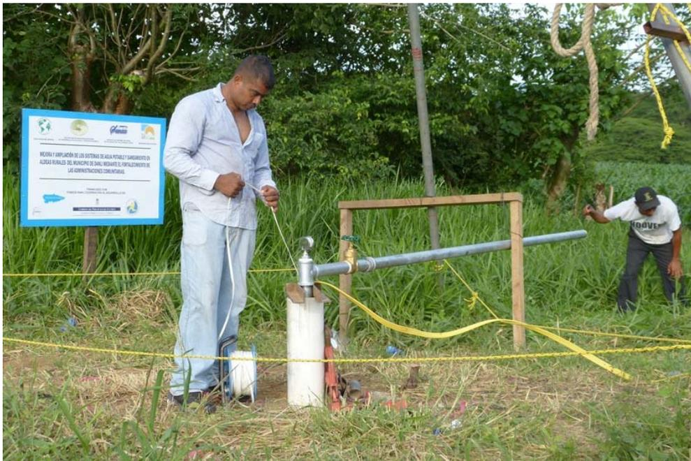
**Figura 93.- Instalación del ensayo. Medida del nivel de agua inicial.**
