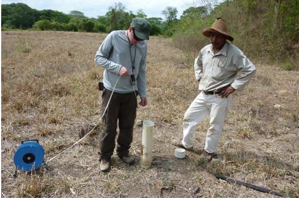
**Figura 151.- Midiendo niveles de agua en pozo mediante freatómetro.**
