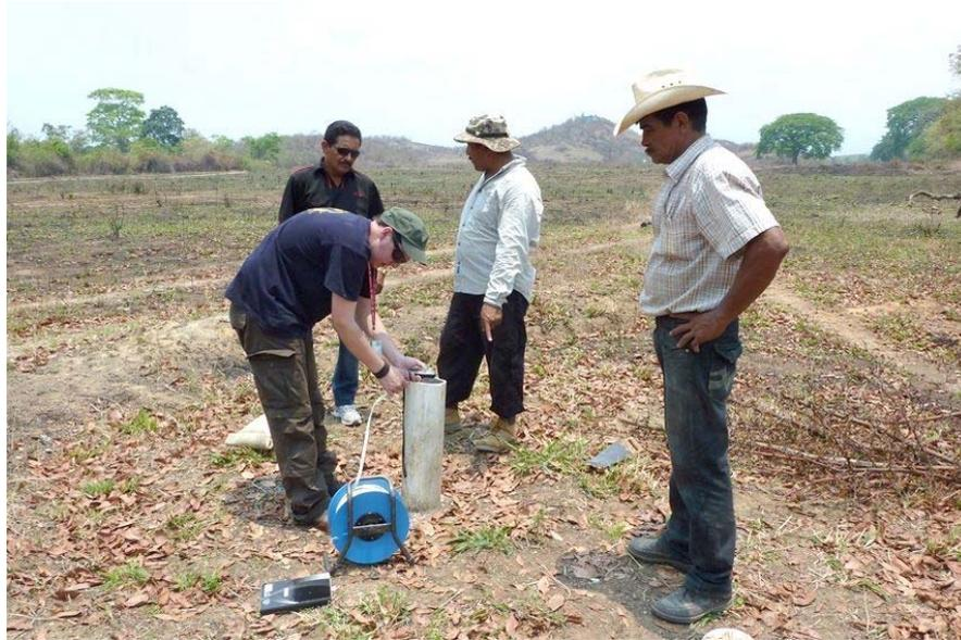
Figura 80.- Midiendo niveles de agua en pozo mediante freatómetro.
