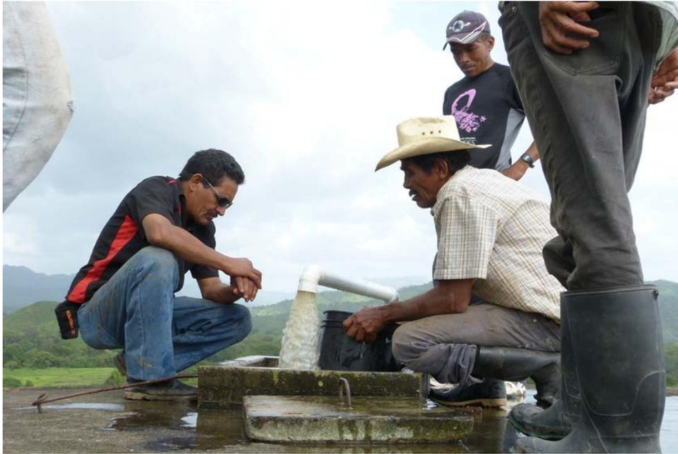
*Figura 120.- El técnico del SANAA, D. Ernesto Flores, aforando en el tanque. El resultado fue similar al de la boca del sondeo.*
