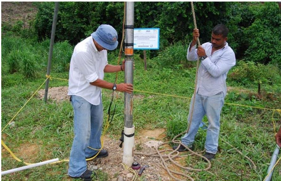
**Figura 164.- Colocación de bomba sumergible para el ensayo de bombeo.**
