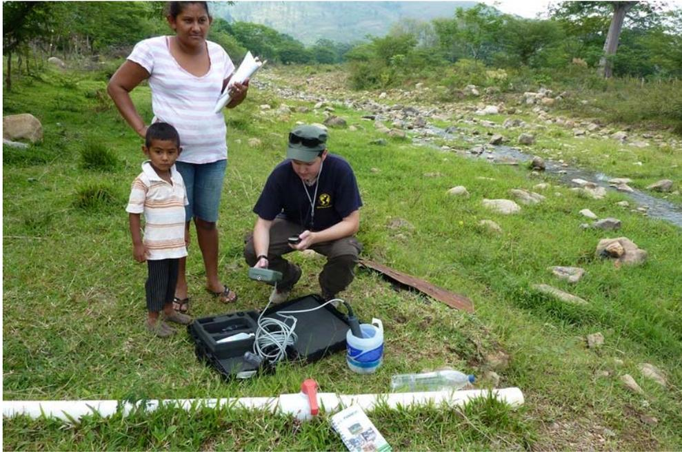
*Figura 20.- Midiendo parámetros de agua del río con sonda multiparamétrica.*
