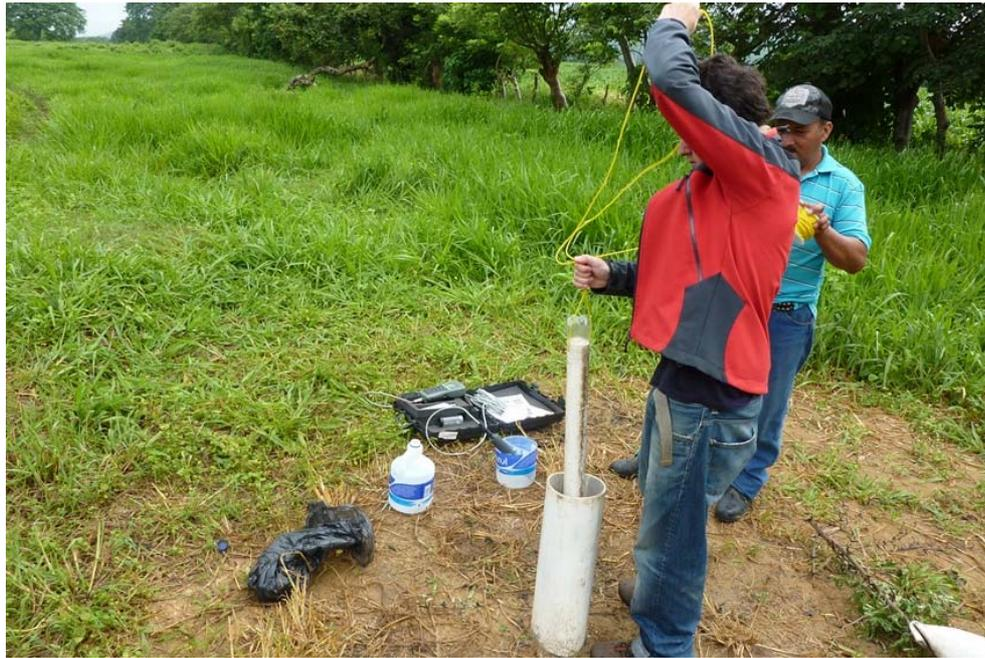
**Figura 99.- Operación de la toma de muestras mediante un tomamuestras para pozos de construcción "casera" realizado con ayuda de los técnicos del SANAA.**
