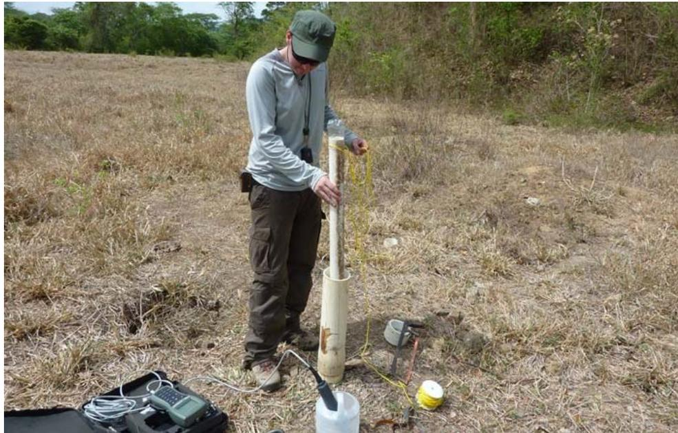
**Figura 153.- Toma de muestra en pozo para análisis mediante sonda multiparamétrica.**
