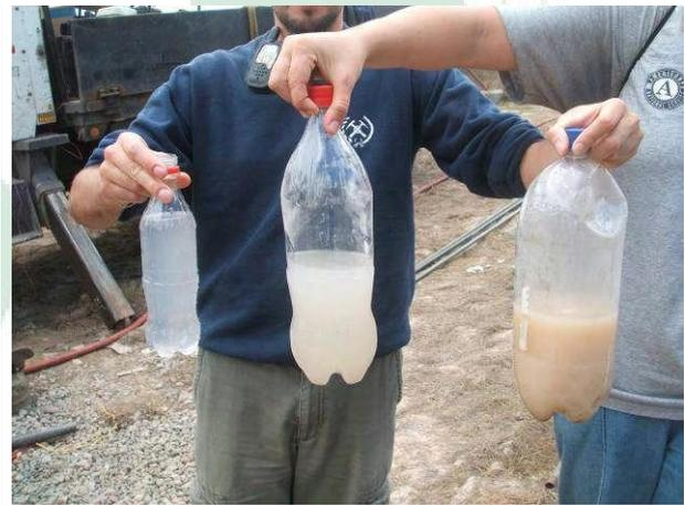
**Izquierda: Aspecto del primer agua al empezar la limpieza. Derecha. Tres muestras diferentes de agua que muestran la evolución y limpieza del agua. Derecha: Al momento de empezar. Centro: Transcurridas 4 horas. Izquierda: A falta de una hora para la finalización de la prueba.**
