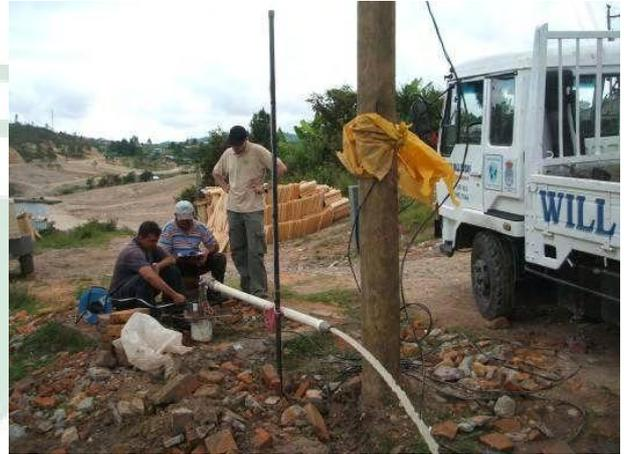
**Izquierda: Tomando medidas en el piezómetro. Derecha: Aforo del pozo**
