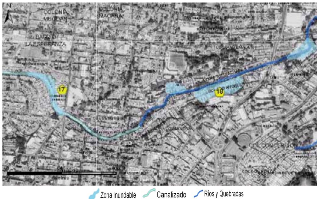
Figura 5.22. Arenal Tutunichapa entre avenida España y calle 5 de Noviembre. Elaboración propia sobre ortofoto. (Fuente ortofoto: CNR). Se señala con una línea amarilla la sección para la que se ha calculado el caudal pico durante la crecida del Stan 2005. (Ver apartado 4.2.3)
