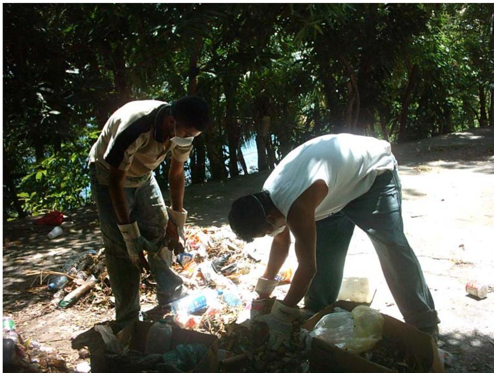
Imagen 8. Método del cuarteo: descarte de un cuarto de la muestra
