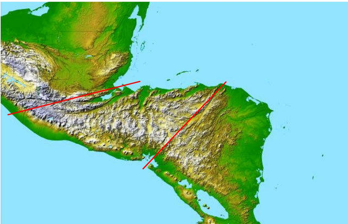
d) *Fallas de desgarre interrumpidas*. Al sur de la falla de Motagua y al oeste de la depresión de Honduras, se encuentran algunas fallas de desgarre inactivas, mostrando evidencias de estar afectadas por las más recientes fallas normales. Los registros sísmicos muestran que la característica tectónicamente activa es la de las fallas normales.
