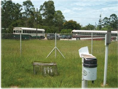
**Imagen 2.1:** Ubicación antigua de la estación meteorológica mostrando un aparcamiento de autobuses contiguo a la misma y el mal estado de los geotermómetros.
