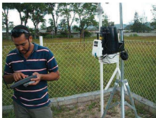
Imagen 2.4: Izquierda, parte del instrumental adquirido antes de ser colocado en el predio de la estación meteorológica. A la derecha, el equipo instalado en la estación meteorológica. En la imagen aparece nuestro promotor social Noé Mercado con la consola de control en las manos donde se registran todos los parámetros.
