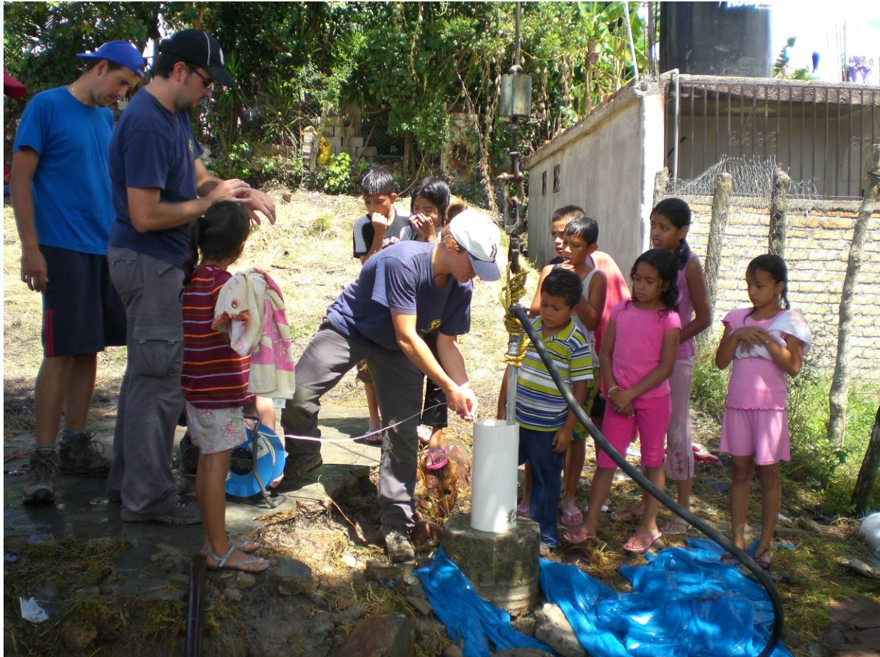
Medición durante la prueba de recuperación
