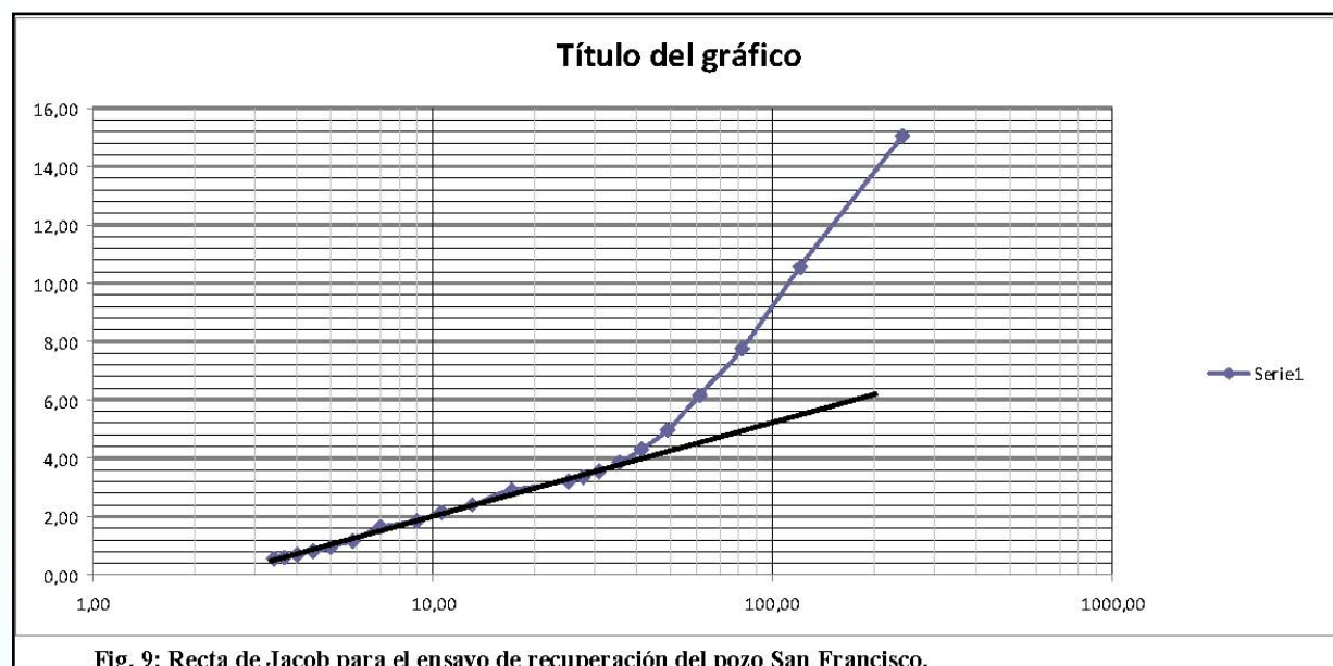
Fig. 9: Recta de Jacob para el ensayo de recuperación del pozo San Francisco.
