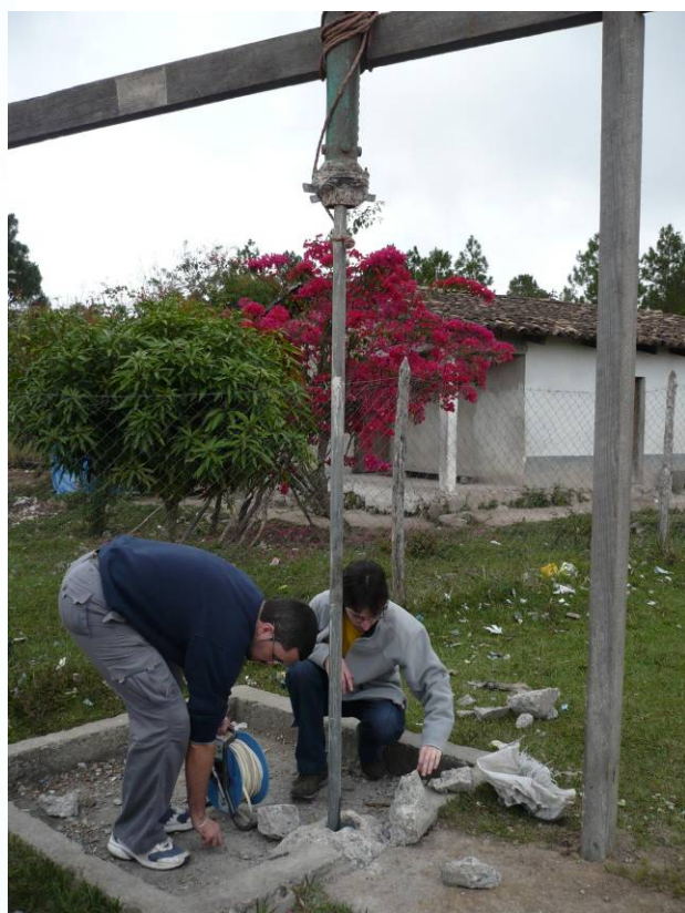
Medición del nivel freático. Por desgracia los pozos estaban secos.
