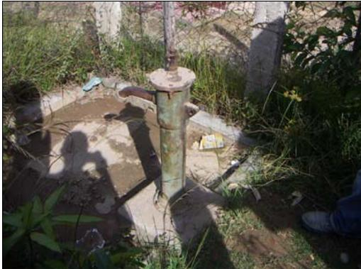
Foto 5: Sondeo con bomba de pichel que se utilizó como piezómetro 1 durante los ensayos de bombeo.
