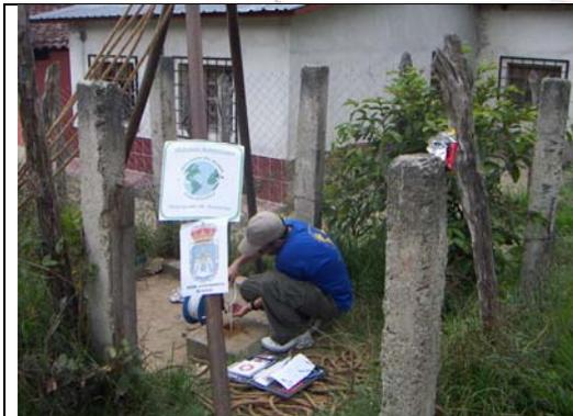
Foto 6: Sondeo que se utilizó como piezómetro 2 durante el primer ensayo de bombeo.
