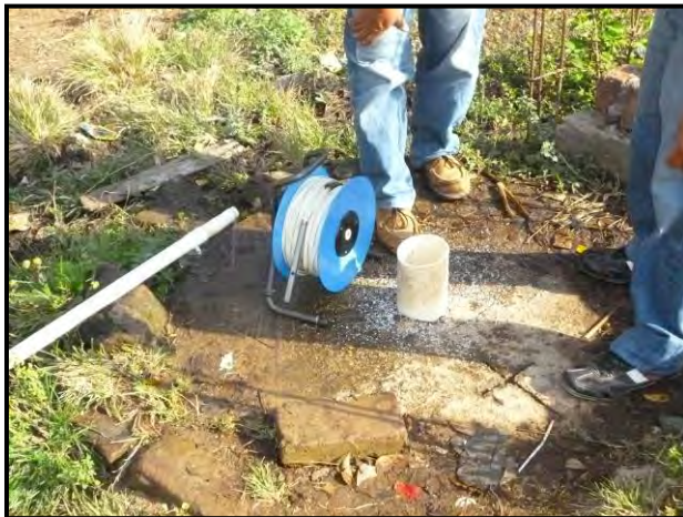
Imágenes 21 y 22: Izquierda: Hidronivel listo para medir el nivel del pozo perforado por el Club Rotario. Derecha: Medida del nivel freático en uno de los pozos malacates.
