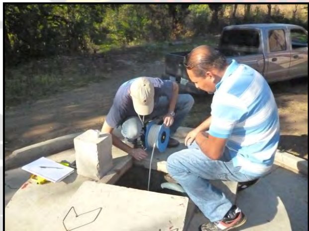
Imágenes 21 y 22: Izquierda: Hidronivel listo para medir el nivel del pozo perforado por el Club Rotario. Derecha: Medida del nivel freático en uno de los pozos malacates.
