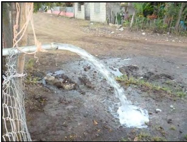
Imágenes 38 y 39: Izquierda. Caudal de extracción de 103 gal/min. Derecha: Medición del nivel dinámico.
