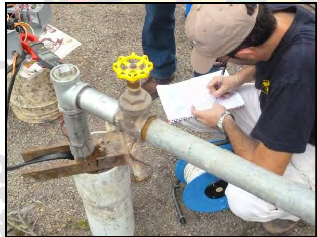
Imágenes 38 y 39: Izquierda. Caudal de extracción de 103 gal/min. Derecha: Medición del nivel dinámico.
