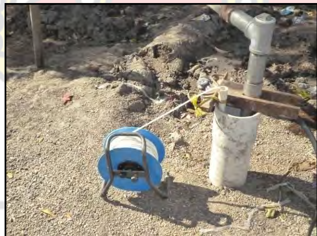
Imágenes 36 y 37: Izquierda: Conexión de la bomba a la red. Derecha: A punto de comenzar el aforo, con el hidronivel emplazado en el pozo.
