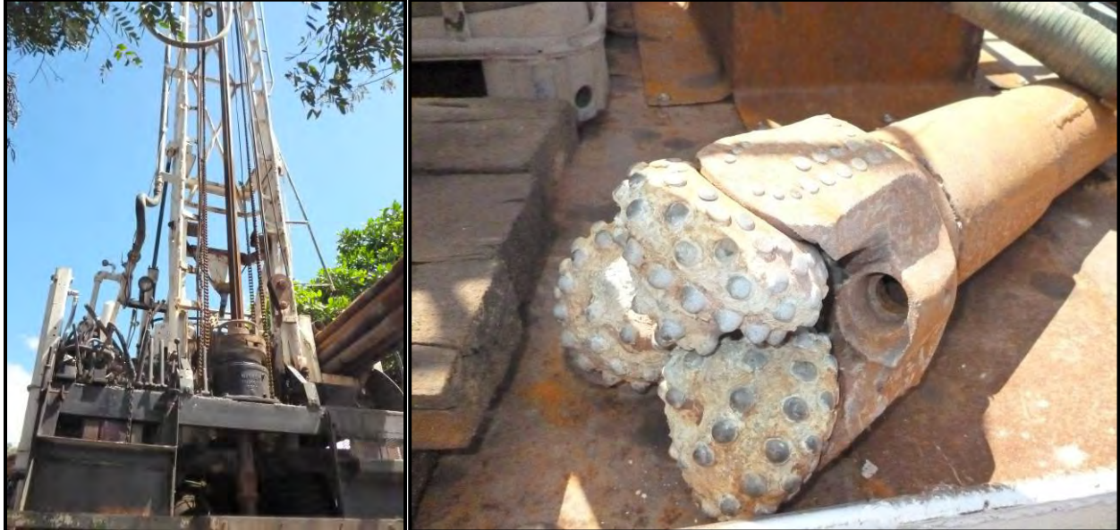
Imágenes 29 y 30: Izquierda: Máquina de perforación mostrando la mesa de rotación. Derecha: Tricono, de insertos de widia, para rocas de dureza media-blanda.
