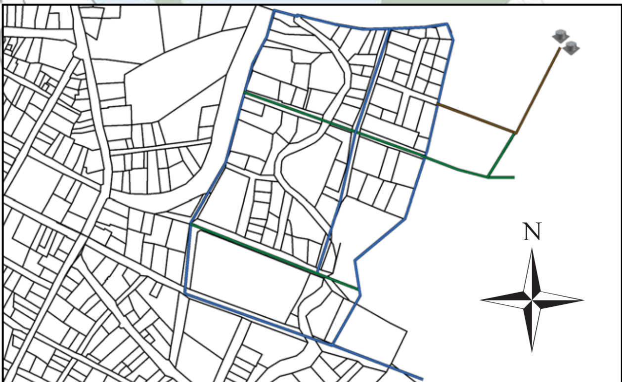
Detalle de las tuberías: En Marrón sección de 6". En azul sección de 4". En verde, sección de 3". Longitud total de tuberías instaladas: 3378 metros.
