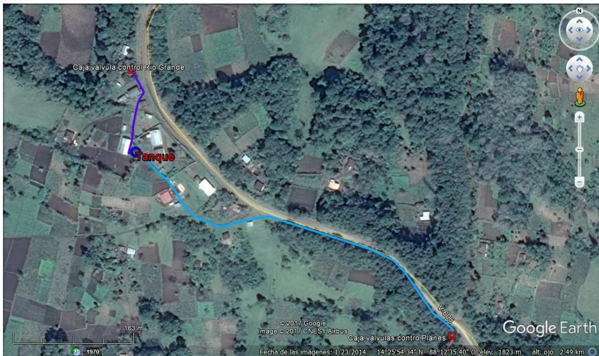
Trazado finalmente elegido para las nuevas tuberías de distribución instaladas. En azul claro el tramo de distribución para el sistema de Planes; en azul oscuro el correspondiente a Río Grande.
