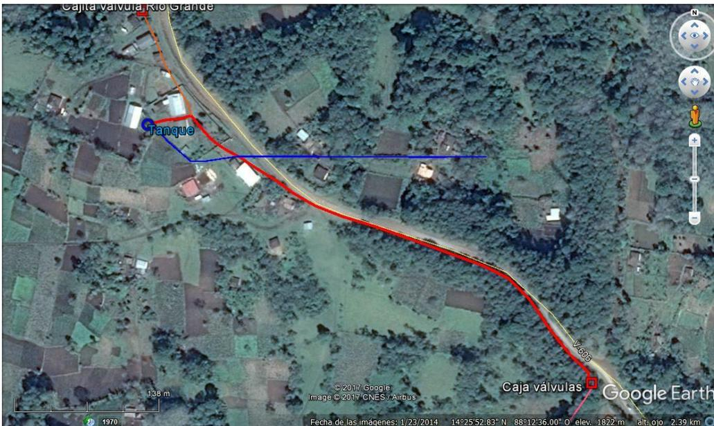
Esquema del sistema de agua de Planes-Río Grande en el entorno del depósito de almacenamiento. La línea azul es la línea de conducción de  $\varnothing$  2” procedente de Manazapa y de entrada al tanque. Las líneas rojas las salidas de distribución; la más gruesa  $\varnothing$  4” para Planes, y la más fina  $\varnothing$  1 ½ “ hacia Río Grande. Construido el nuevo depósito se dieron salidas independientes desde el mismo.
