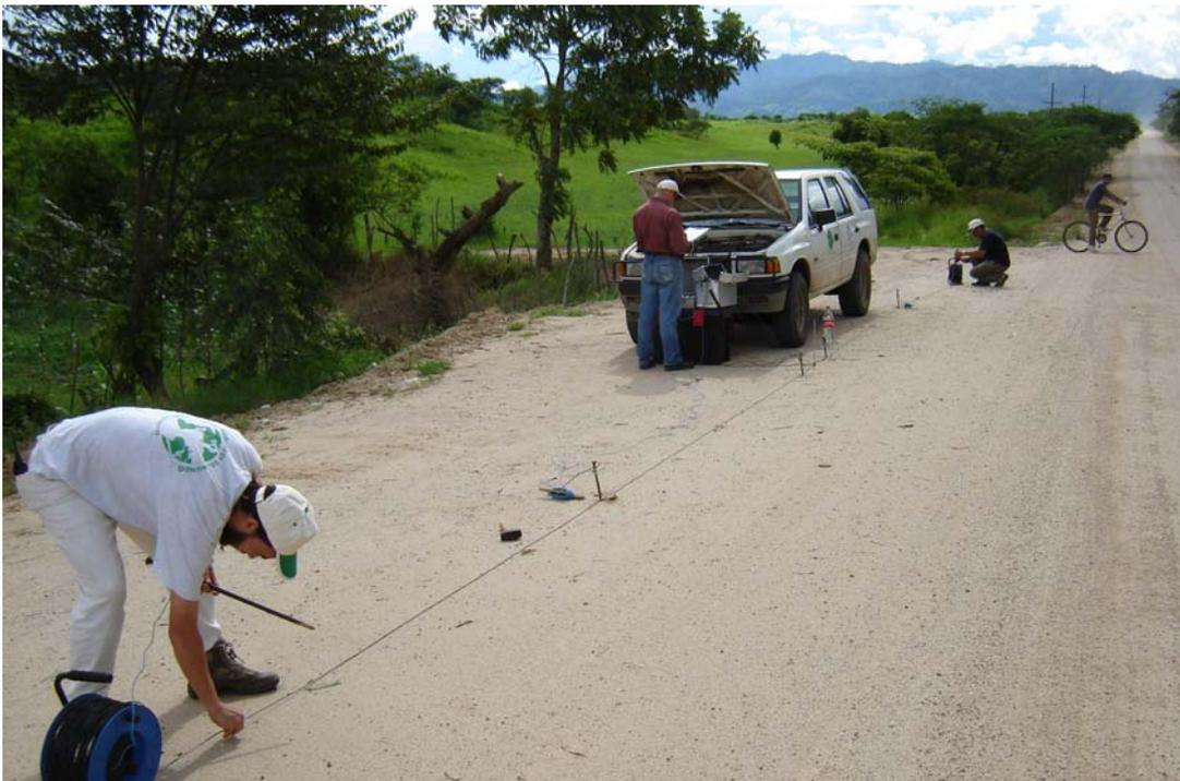
Al hacer circular corriente en el terreno se mide simultáneamente el valor de dicha corriente y el del potencial eléctrico que aparece entre los electrodos.
