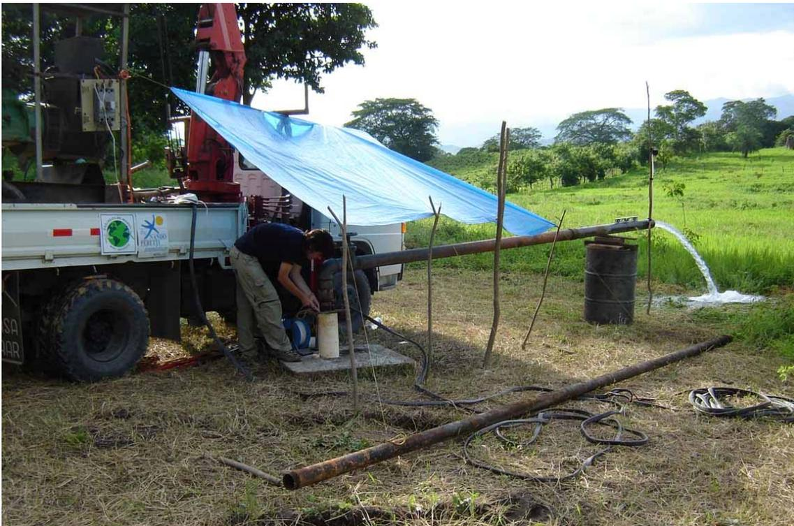
Foto 3.2.3. Ensayo de bombeo del pozo de El Zapotillo (Julio 2005).
