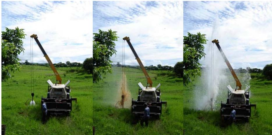
Tras la limpieza del pozo de El Zapotillo, se procedió a realizar el ensayo de bombeo escalonado y ensayo a caudal constante de larga duración. El ensayo de bombeo a caudal variable sirvió para establecer los descensos y así determinar el caudal de bombeo para el aforo.
