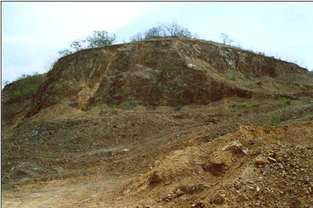
Foto 10.12 – P. de R. N° 284 Cantera en la cual se explotan las rocas parcialmente meteorizadas.
