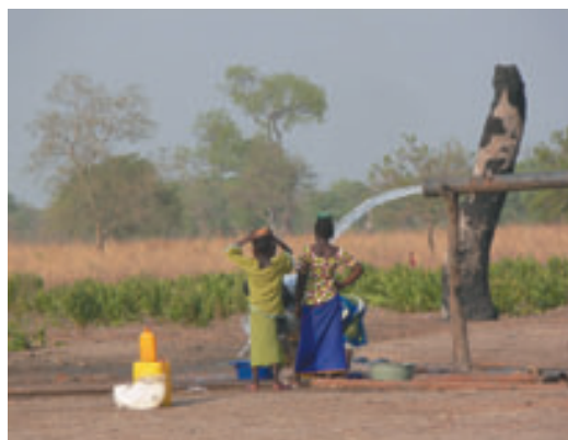
Ensayo de bombeo
