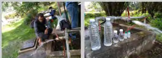
Toma de muestra en uno de los puntos de Tiquipaya, municipio situado al norte del valle de Cochabamba. La muestra se divide en varias alícuotas en función de la analítica a realizar y los criterios de conservación.
