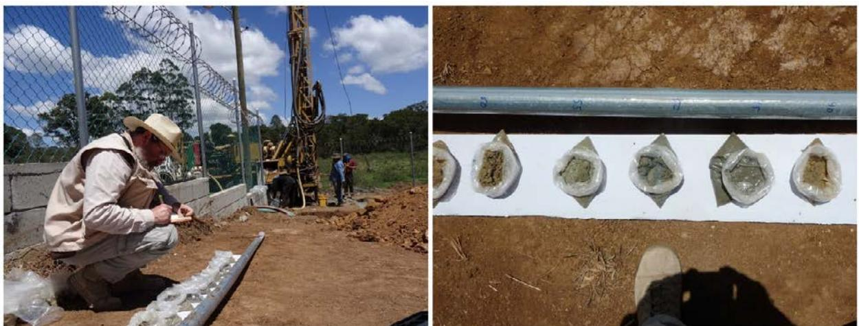
Muestreo de ripio de las rocas atravesadas por la perforación.
