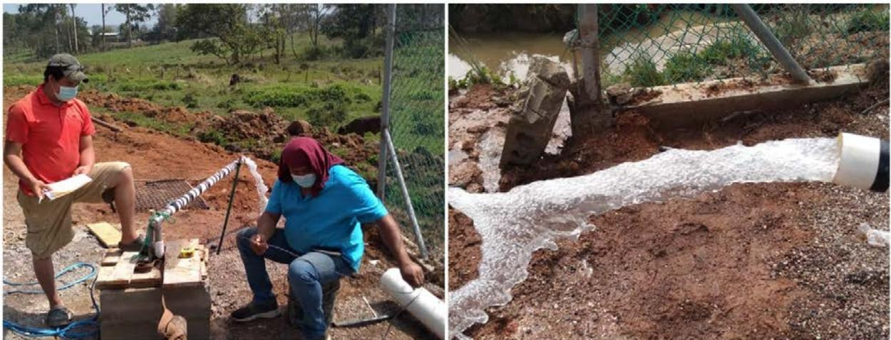
Ensayo de bombeo en el que se extrae agua a un caudal conocido y se controla la secuencia tiempo-descenso hasta alcanzar el nivel dinámico; posteriormente se controla la misma secuencia con la recuperación del nivel de agua.
