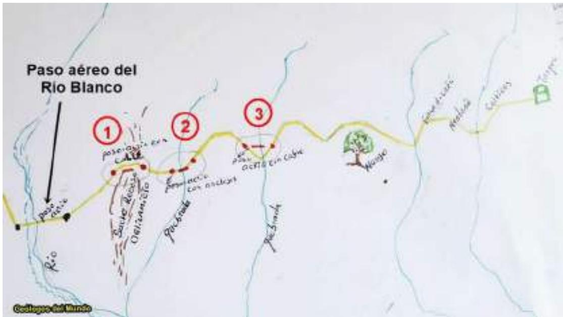
Figura 156.- Esquema de los puntos en los que la afección de los huracanes a la línea de conducción de Valle de Ángeles fueron de mayor importancia. Se indican los nuevos pasos aéreos a construir en sustitución del enterramiento de la tubería debido a las nuevas condiciones orográficas dejadas por la erosión de las quebradas.
