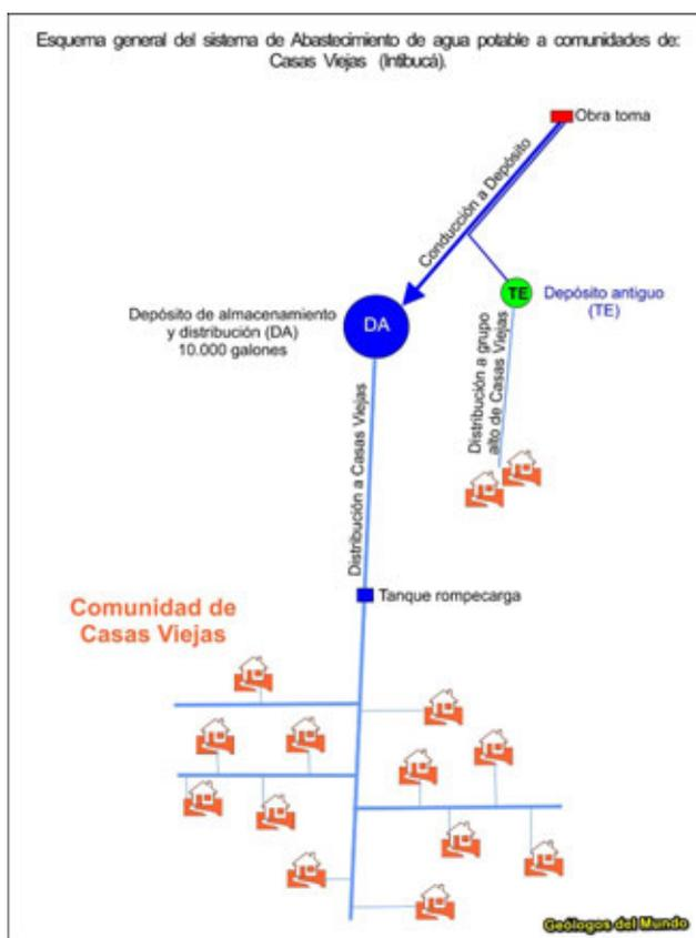
Figura 8.- Esquema del abastecimiento de agua potable realizado para beneficio de Casas Viejas.
