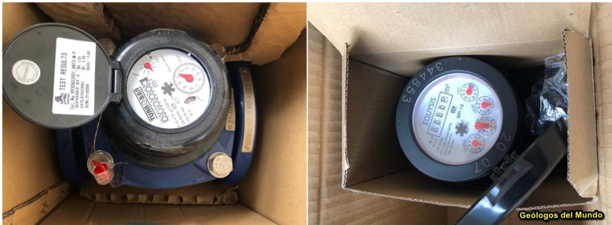
Figura 19.- También llegan los tres (3) macromedidores y los catorce (14) micromedidores que se instalarán. Los primeros en las salidas del depósito de almacenamiento y distribución, y los segundos en cada una de las fuentes comunitarias.
