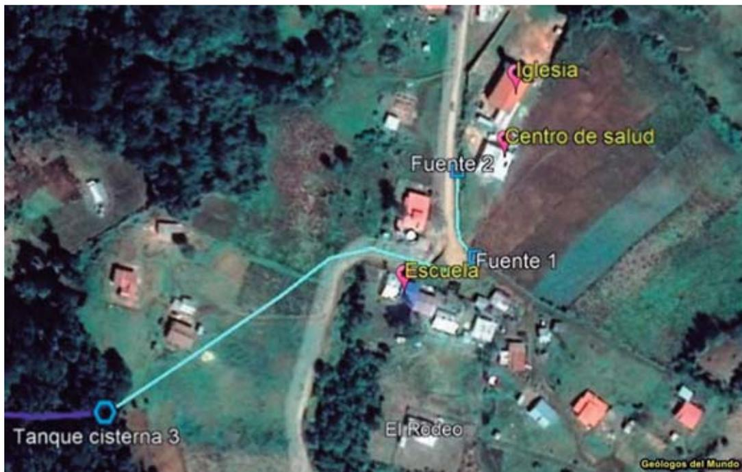
Figura 87.- Localización de las fuentes comunitarias construidas en El Rodeo Centro. La línea azul celeste corresponde con la traza de la tubería de conducción e interconexión entre fuentes; el tramo hasta las escuelas forma ya parte de un tramo de la línea de impulsión de la Fase 2 del proyecto, de este modo se conmutará su función entre conducción por gravedad (cuando no exista bombeo) y de impulsión con bombeo.
