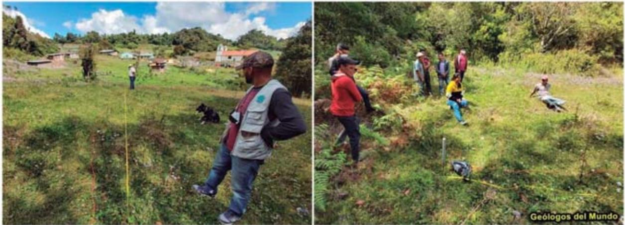
Figura 13.- Ejecución de un segundo perfil geoelectrico en las inmediaciones de El Rodeo Centro.
