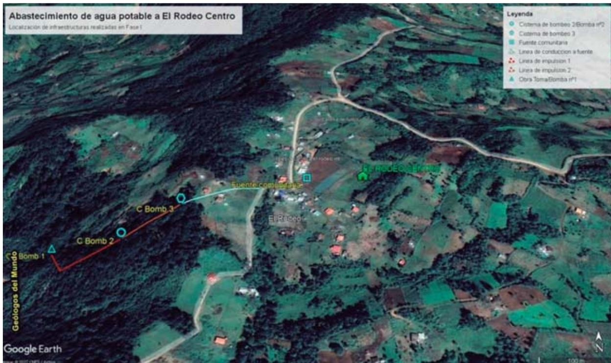
Figura 26.- Localización de las diferentes unidades de obra realizadas. Además de la obra de estructuras y de la consiguiente tubería de impulsión, en la obra toma (OT/Bomb1) se realizó también la instalación de una bomba sumergible de 7,5 Hp con sus correspondientes controles; en la cisterna de bombeo 2 (C Bomb 2) se instaló una bomba centrífuga de eje vertical (7,5 Hp); y todo el tendido eléctrico necesario para la conexión desde la cisterna de bombeo 3 (C Bomb 3) hasta la obra toma.
