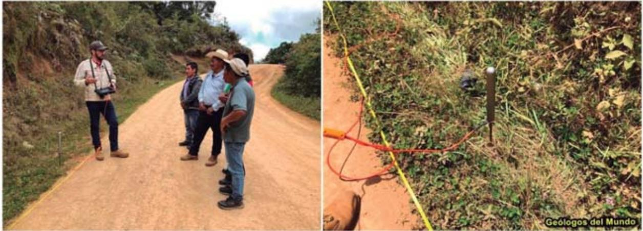
Figura 12.- Realizando uno de los perfiles geofísicos. A la derecha el electrodo de inducción y recepción.
