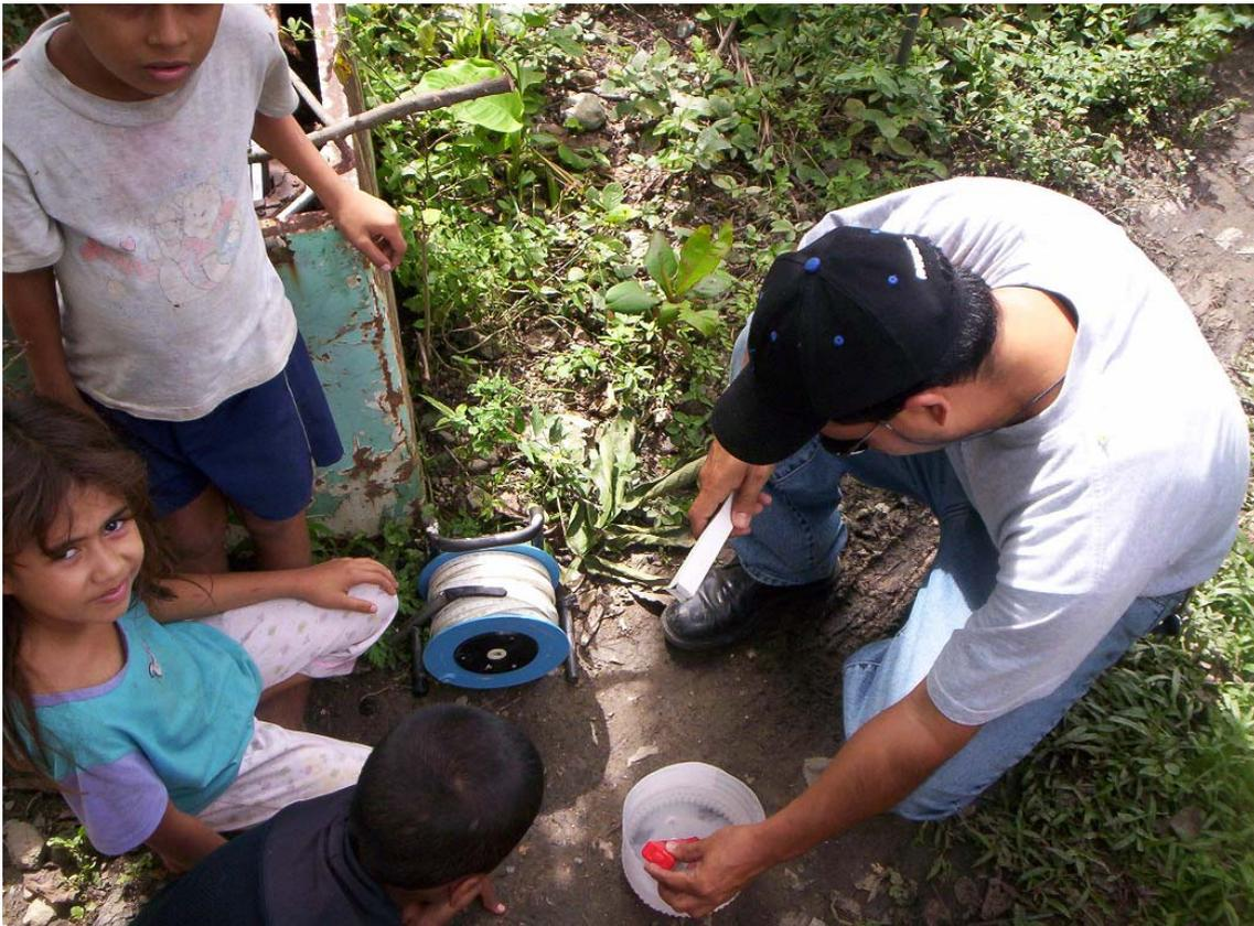
Fotografía 5. Toma de pH, conductividad eléctrica y temperatura en el punto P4.
