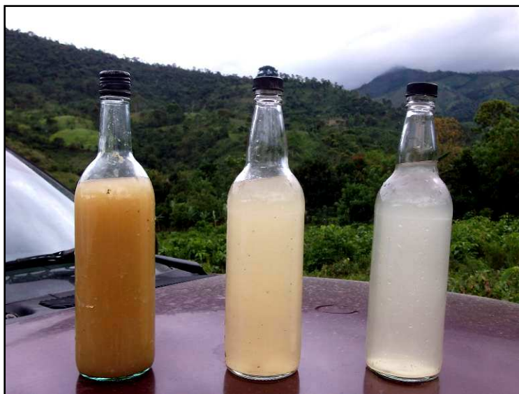
Evolución en la turbiedad de las aguas, desde el comienzo del proceso de limpieza (izda) hasta la obtención de un agua clara (dcha) ocho horas después.
