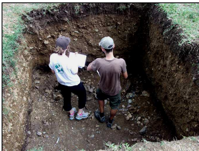
Equipo de Geólogos del Mundo en la Calicata realizada sobre materiales coluviales.
