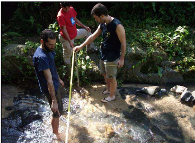
Equipo de Geólogos del Mundo aforando la Quebrada Arena Caliente.
