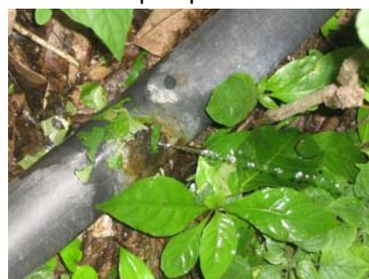
**Fotografía 5.2. Fuga de agua en manguera de conducción**
