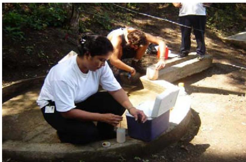
**Fotografía 7.1. Técnica de ENACAL tomando una muestra de agua para los análisis físico-químicos y bacteriológicos**
