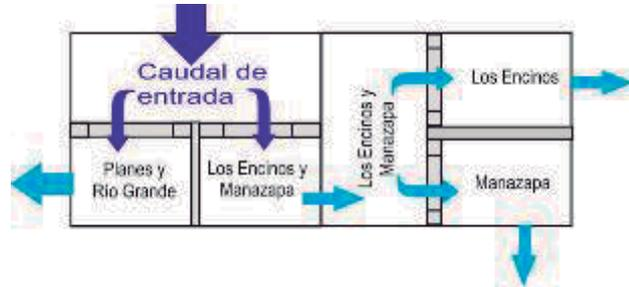
A la derecha esquema del alzado de la caja derivadora existente; a la derecha esquema del funcionamiento de derivación de agua
