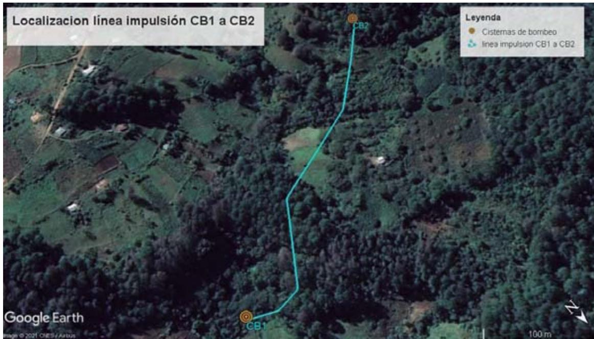
Figura 80.- Trazado de la línea de impulsión entre las cisternas de bombeo 1 (CB1) y 2 (CB2). Base: foto satelital Google Earth.
