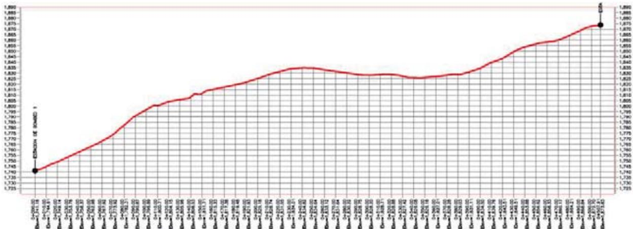
Figura 81.- Perfil topográfico longitudinal de la traza de la línea de impulsión CB1 a CB2. Longitud 507 m; diferencia elevación 134,6 m.
