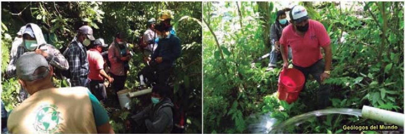
Figura 48.- Concentración provisional del agua de la fuente para la realización de aforo por el método volumétrico. El caudal obtenido en este aforo, mes de marzo, fue de 142 Gal/min (8,9 l/s).
