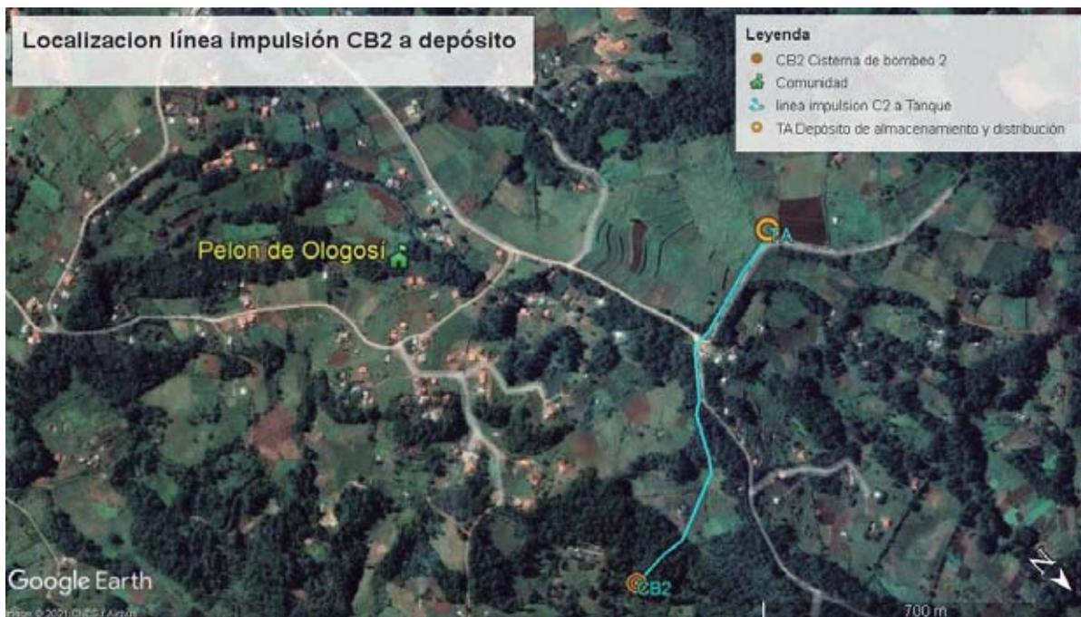
Figura 82.- Trazado en planta del segundo tramo de la línea de impulsión . Cisterna nº 2 a depósito.
