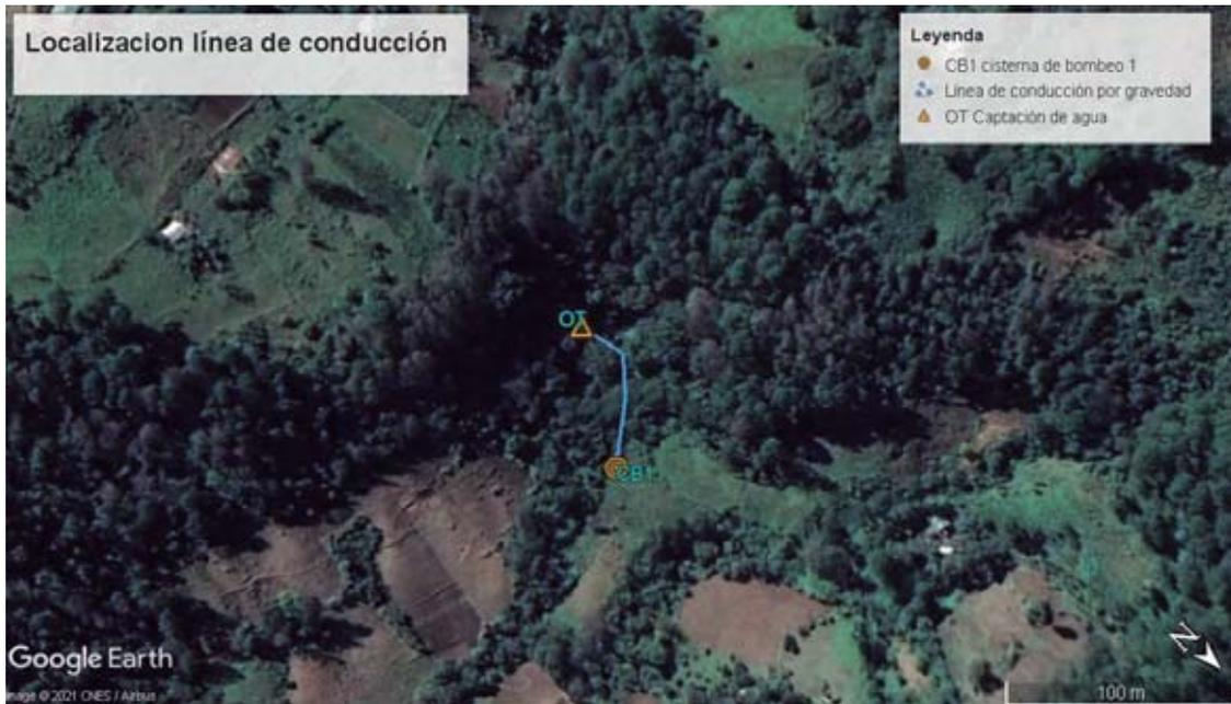
Figura 67.- Localización de la traza de la línea de conducción por gravedad entre la captación y la primera de las cisternas de bombeo (CB1). Base: fotografía satelital Google Earth.
